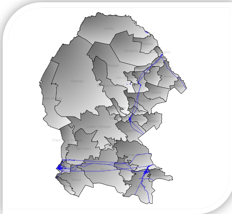
Mapa de red de transporte que se compone de los segmentos de agregación y distribución de fibra óptica a nivel municipal.
